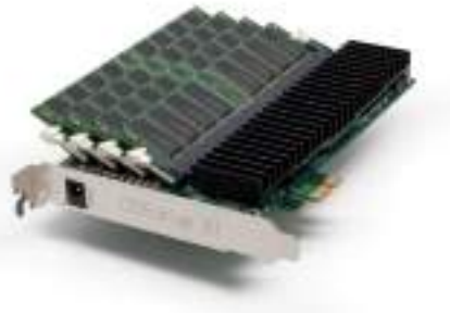
Figura C.4: Unidad de estado sólido basado en RAM: DDRdrive X1 (imagen de la Wikipedia: Solid state drive ).
