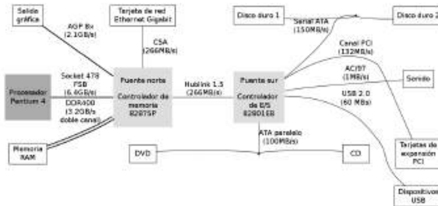
Figura 2.4: Esquema simplificado del chipset Intel 875 (para el procesador Pentium 4) ilustrando la velocidad de cada uno de los canales.
