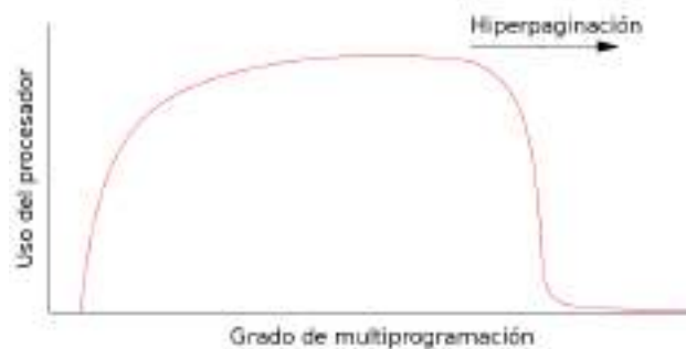
Figura 5.20: Al aumentar demasiado el grado de multiprogramación, el uso del CPU cae abruptamente, entrando en hiperpaginación (Silberschatz, Galvin y Gagné 2010: 349).
