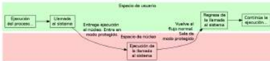
Figura 2.5: Transición del flujo entre espacio usuario y espacio núcleo en una llamada al sistema.
