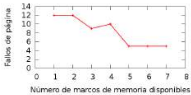
(b) Comportamiento del algoritmo *fifo* exhibiendo la anomalía de Belady al pasar de tres a cuatro marcos.
