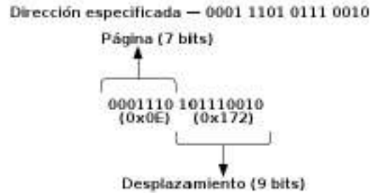
Figura 5.7: Página y desplazamiento, en un esquema de direccionamiento de 16 bits y páginas de 512 bytes.
