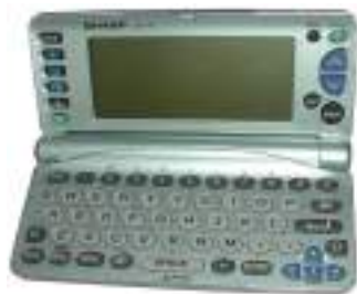
Figura 1.7: Sharp ZQ-770, diseño bajo uno de los formatos de PDA (Asistente Personal Digital) más popularizados de la década de los noventa (imagen de la Wikipedia: Sharp Wizard ).
