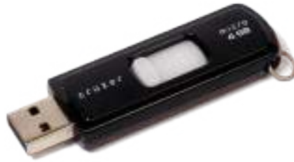
Figura C.6: Unidad de estado sólido basado en flash con interfaz USB (imagen de la Wikipedia: Solid state drive ).
