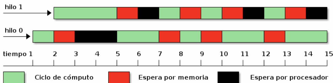
Figura 5.21: Alternando ciclos de cómputo y espera por memoria, un procesador que implementa hilos hardware ( hyperthreaded ) se presenta como dos procesadores
