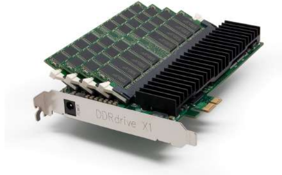
Figura C.4: Unidad de estado sólido basado en RAM: DDRdrive X1 (Imagen de la Wikipedia: Solid state drive )
