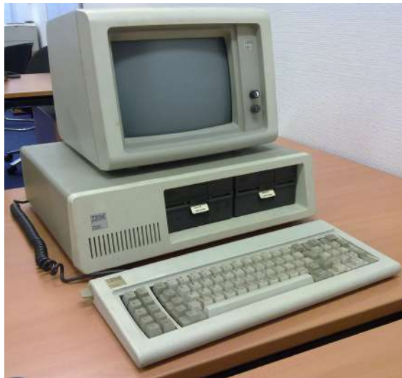
Figura 2.3: La computadora IBM PC modelo 5150 (1981), iniciadora de la arquitectura predominantemente en uso hasta el día de hoy. (Imagen de la Wikipedia: IBM Personal Computer )
